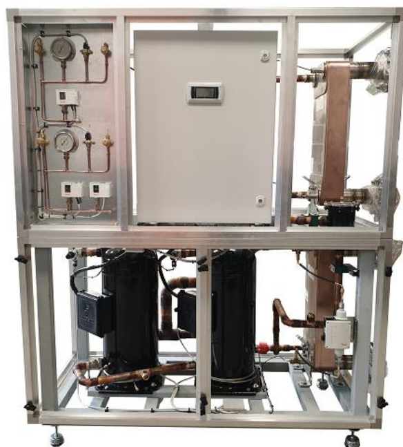
Фигура 7.2 Термopомпа вода-вода, работеща с R134a
